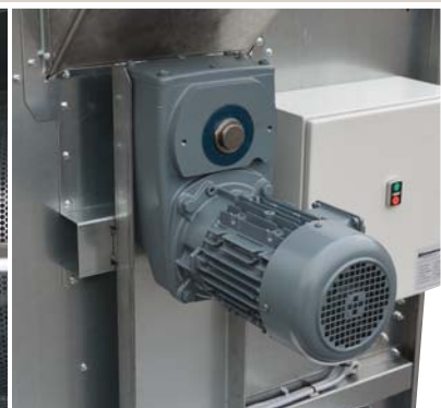
Síťovým bubnem, který je poháněn převodovým motorem, lze snadno otáčet – výměna sítí je pak jednoduchá.
