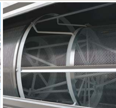
Dvě vrstvy sítí: první (vnitřní síť) pro nečistoty, které jsou větší než zrnka čistěné plodiny, druhá (vnější síť) pro nečistoty, které jsou menší.
