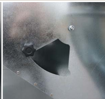
Otvor pro odebrání kontrolního vzorku čišťené plodiny.
