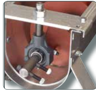
Uchycení šneku v nastavitelných kuličkových ložiskách
