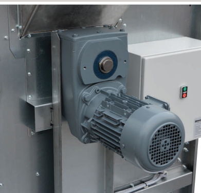
Sítový buben s převodovkou s rovnoběžnými hřídelemi; bubnem lze lehce otáčet, a tak snadno měnit síta.
