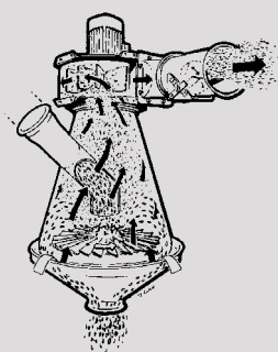
KF 40 – princip práce
