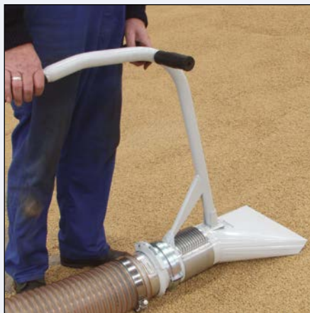
Čistící sací hlava – k vysávání zbytků obilí z podlah. Nižší přepravní výkonnost. Je vybavená kolečkem a otočnou spojkou mezi hlavou a hadicí.
